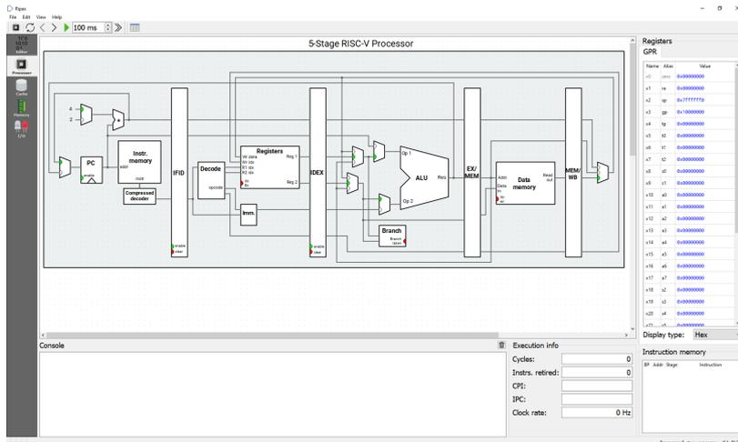
**Figura 1.5.** Vista por defecto de la GUI de Ripes tras iniciarse. Los botones situados en el margen izquierdo, con un color de fondo más oscuro, son los encargados de cambiar entre las vistas ofrecidas.
