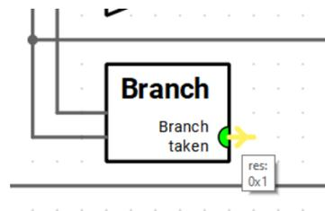
Figura 4.3. En la misma etapa EX se verifica la condición que determina si la salida de la ALU se asignará o no al contador de programa.
