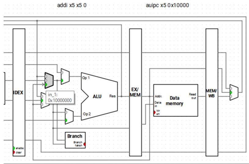
**Figura 3.11.** Con los adelantamientos activados, la etapa en la que se precisa el operando, en este caso el registro **x5** en la etapa EX, puede obtener su valor sin esperar a que se escriba en el banco de registros. Observa el detalle de la etiqueta del multiplexor de la etapa EX que muestra el valor que se está recibiendo desde la etapa posterior.
