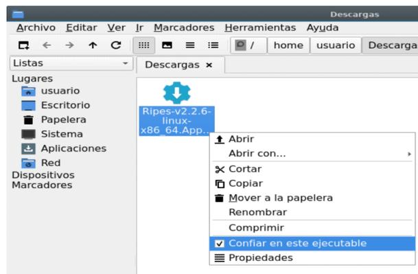
**Figura 1.4.** Configuración para poder ejecutar Ripes en GNU/Linux.
