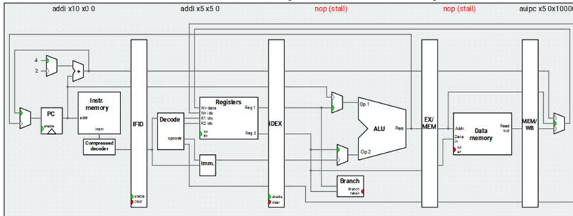
**Figura 3.10.** Con la nueva configuración la CPU dispone de la circuitería precisa para detectar los riesgos de datos y evitarlos, para lo cual se introducen de manera automática las detenciones que se precisen en el cauce de ejecución.
