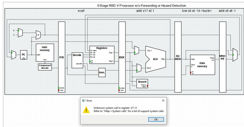
**Figura 3.4.** Error al ejecutar el programa en un cauce segmentado. La CPU procesa varias instrucciones en paralelo sin efectuar ningún tipo de comprobación, por lo que surgen situaciones inesperadas.
