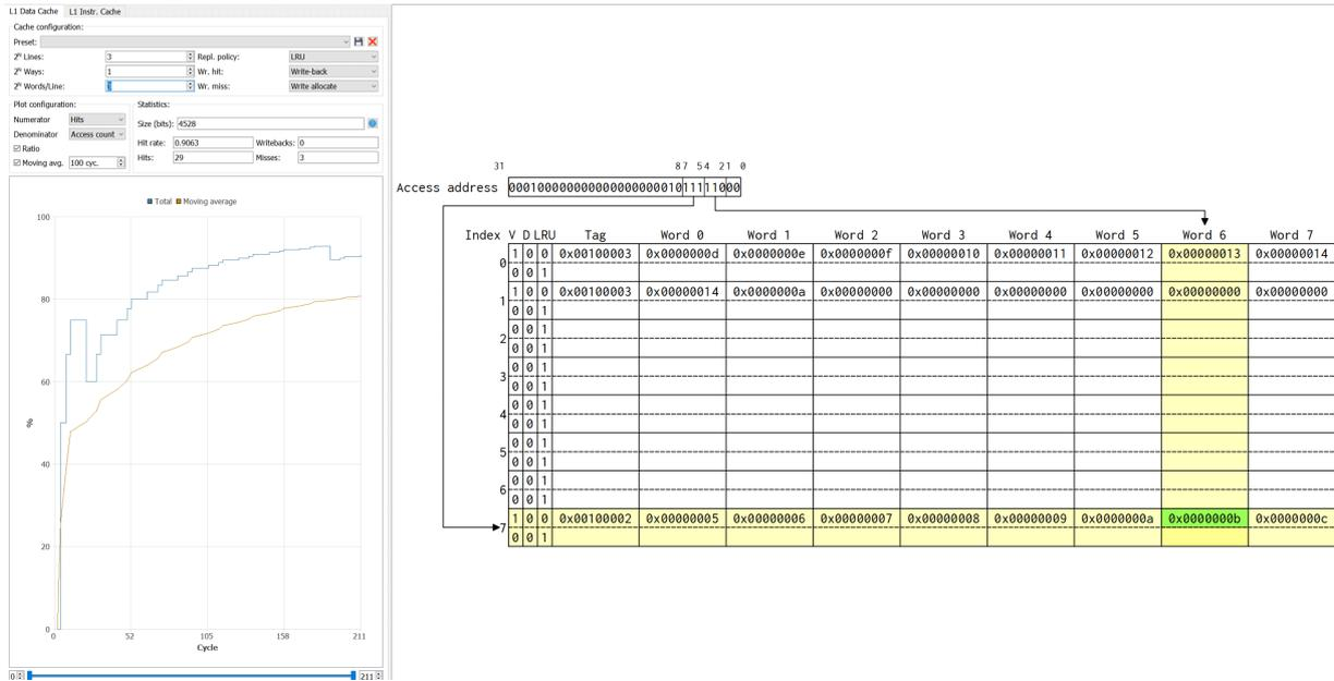
**Figura 6.1.** Vista **CACHE** del simulador Ripes. En la parte superior izquierda se encuentran los controles de configuración de la caché. Debajo los conteos de aciertos, fallos y ratio de aciertos, así como la gráfica obtenida al representarlos. La parte derecha está ocupada por el diagrama de la caché, en este caso la de datos, con la información relativa a un acceso concreto durante la ejecución paso a paso de un programa.
