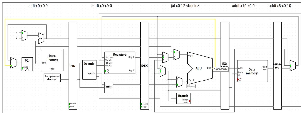
Figura 4.2. La nueva dirección del contador de programa se calcula en la etapa EX y se devuelve como entrada al `pc` en el siguiente ciclo de ejecución.
