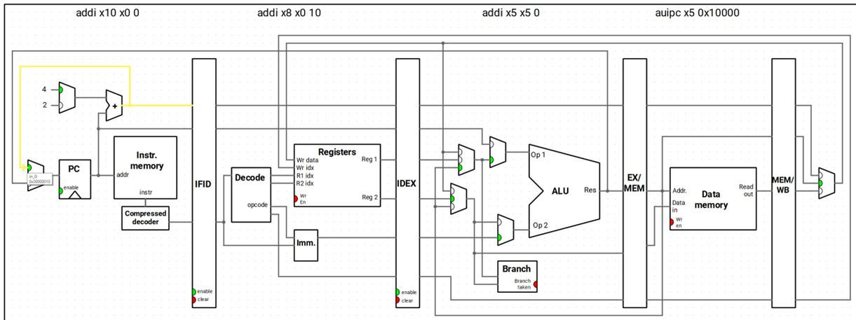
**Figura 4.1.** El **pc** se actualiza en cada ciclo, por defecto con la salida que genera un sumador —situado en la etapa IF— que incrementa el anterior valor del mismo registro. Observa que la entrada del **pc** proviene de un multiplexor cuya primera entrada (la superior) procede de dicho sumador.
